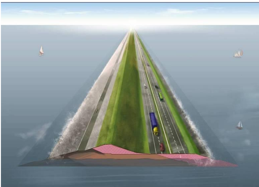
Figuur 4.2 2100-Robuust (21R): illustratie doorsnede van verhoogd en verbreed dijklichaam
